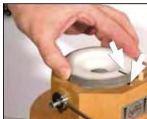
Рис. 7 Поставьте ручку настройки помола в горизонтальное положение. Вложите и закрепите верхний камень совместив маркировку на камне с маркировкой нанесённой на корпусе. Поставьте бункер на место и закрепите его шурупами.
