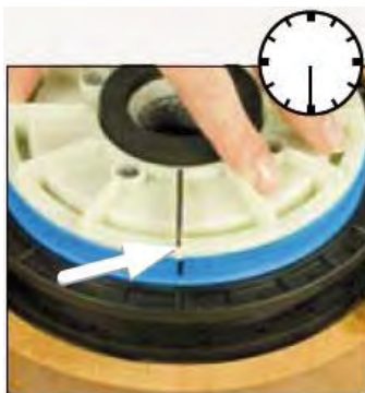
Рис. 7 Строго горизонтально вложите верхний камень в пластиковое кольцо. При этом маркировка на камне должна находиться в положении «6 часов».
