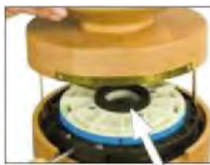
Рис. 9: Проверьте правильность положения резинового уплотнительного кольца. Установите бункер на место и закрутите латунные винты
