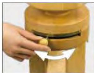
Рис. 5: Установка степени помола регулируется поворотом ручки влево – мелкий помол, вправо – грубый помол
