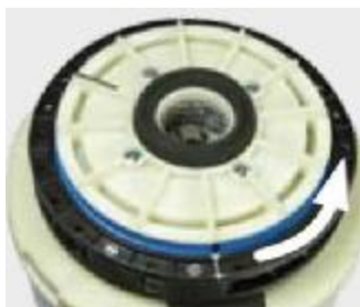
Рис. 4 Открутите верхний камень на пластиковом кольце (с большим усилием!) против часовой стрелки.
