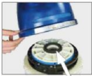
Рис. 7 Проверьте правильность положения резинового уплотнительного кольца. Установите бункер на место, закрутите крепёжный винт и ручку настройки помола.
