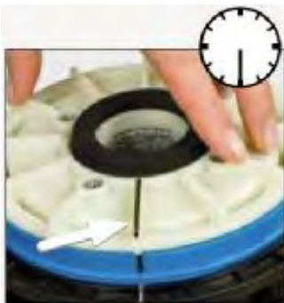
Рис. 5 Строго горизонтально вложите верхний камень в пластиковое кольцо. При этом маркировка на камне должна находиться в положении «6 часов».
