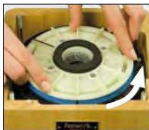
Рис. 6 Откройте верхний камень на пластиковом кольце (с большим усилием!) против часовой стрелки.
