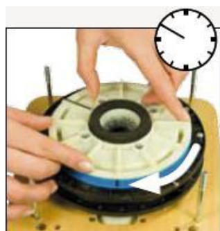
Рис. 8 Слегка надавите камень сверху и прокрутите один полный оборот, а затем ещё до «10 часов» вплоть до его остановки.
