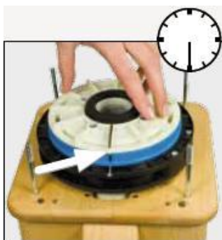
Рис. 7 Строго горизонтально вложите верхний камень в пластиковое кольцо. При этом маркировка на камне должна находиться в положении «6 часов».
