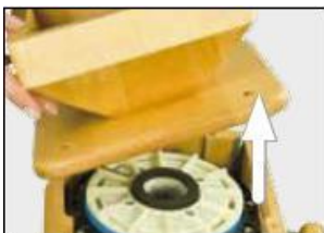
Рис. 2: Снимите бункер для зерна
