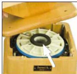
Рис. 9: Проверьте правильность положения резинового уплотнительного кольца. Установите бункер на место и закрутите латунные винты
