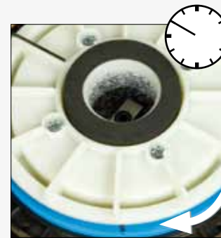
Figura 8 Ao atarraxar, observe que os mós não seja emperrado.
