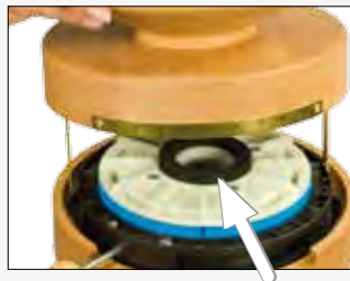
Figura 4 Controlar a posição correta da vedação de borracha (seta). Colocar o funil e fixar novamente com os parafusos de latão.
