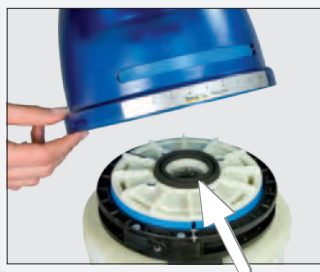
Obrazek 4 Sprawdzić prawidłowe ułożenie gąbczastej uszczelki (strzałka). Lijek usadzić i przykręcić śrubą mocującą, zamocować dźwignię regulacji grubości mielenia.
