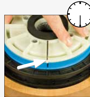
Fig. 7 Le tacche nere devono combaciare l'una sull'altra.
