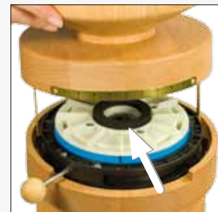
Fig. 9 Controllare se la guarnizione in gomma spugna è correttamente in sede (freccia). Applicare la tramoggia e stringere nuovamente le viti di ottone.
