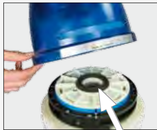
Fig. 4 Controllare se la guarnizione in gomma spugna è correttamente in sede (freccia). Applicare la tramoggia e fissare con la relativa vite di supporto, avvitare la leva di regolazione.
