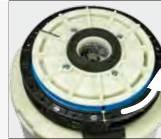
Fig. 6 Svitare la pietra superiore in senso antiorario.
