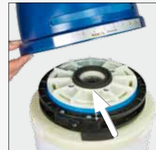
Fig. 9 Controllare se la guarnizione in gomma spugna è correttamente in sede (freccia). Applicare la tramoggia e fissare con la relativa vite di supporto e leva di regolazione.
