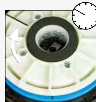
Fig. 8 Avvitando assicurarsi che la macina non si metta di storto.
