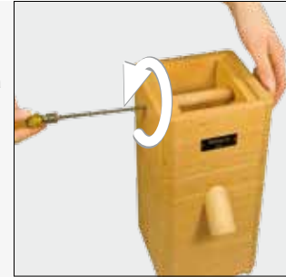
Fig. 4 Rimuovere con un cacciavite la vite di blocco sul lato del corpo opposto alla rotella di regolazione.
