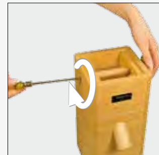
Fig. 7 Riavvitare la vite di blocco, regolare l'agevolezza della rotella di regolazione.
