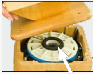
Fig. 4 Controllare se la guarnizione in gomma spugna è correttamente in sede (freccia). Applicare la tramoggia e stringere nuovamente le viti di ottone.
