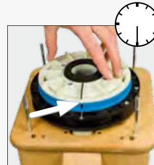
Fig. 7 Le tacche nere devono combaciare l'una sull'altra.
