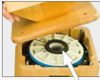
Fig. 4 Controllare se la guarnizione in gomma spugna è correttamente in sede (freccia). Applicare la tramoggia e stringere nuovamente le viti di ottone.
