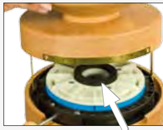
Photo 4 Contrôlez que le joint en mousse de caoutchouc est bien en place (Flèche). Placez l'entonnoir et fixez de nouveau les vis en laiton.
