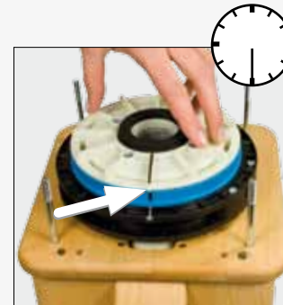
Photo 7 Les marques noires doivent être l'une en face de l'autre.
