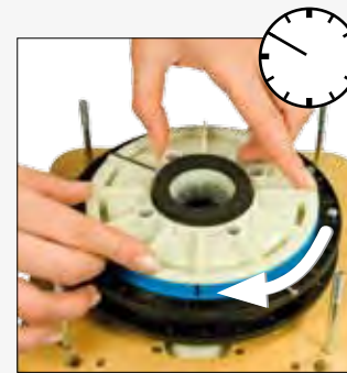
Photo 8 Attention : en tournant, la meule ne doit pas se mettre de travers.
