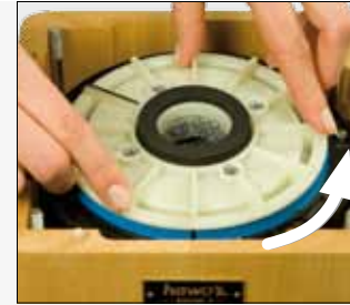
Photo 6 Tourner la meule supérieure dans le sens inverse des aiguilles d'une montre pour la retirer.
