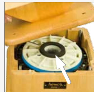
Photo 9 Contrôlez que le joint en mousse de caoutchouc est bien en place (Flèche). Placez l'entonnoir et fixez de nouveau les vis en laiton.
