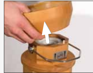
Figura 4 Eleva el protector de encaje y la tolva hacia arriba.
