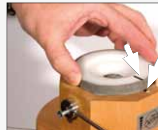
Figura 7 En el ensamblaje ha de procurar que las marcas estén superpuestas cuando se coloque la muela superior.
