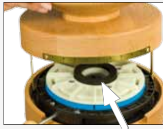
Figura 4 Compruebe el correcto asiento de la junta de caucho celular (flecha). Superponga la tolva y vuelva a sujetarla con los tornillos de latón.
