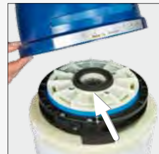
Figura 9 Comprobar el correcto asiento de la junta de caucho celular (flecha). Superponer la tolva y sujetarla con el tornillo de soporte y la palanca de ajuste.
