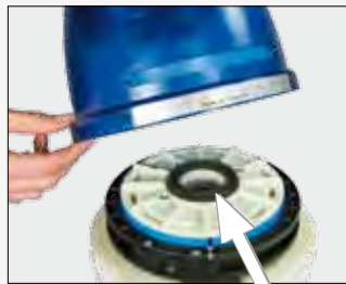
Figura 4 Comprobar el correcto asiento de la junta de caucho celular (flecha). Superponer la tolva y sujetarla con el tornillo de soporte y la palanca de ajuste.
