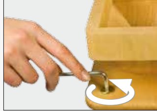
Figura 1 Quitar los cuatro tornillos de latón con la llave Allen adjunta
