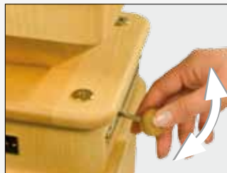
Figura 5 Ajuste del grado de finura: fino hacia adelante, grueso hacia atrás.
