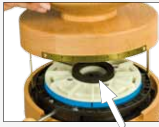
Bild 4 Korrekten Sitz der Moosgummidichtung kontrollieren (Pfeil). Trichter aufsetzen und mit den Messingschrauben wieder befestigen.
