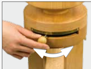
Bild 5 Verstellen des Feinheitsgrads: fein nach links, grob nach rechts.
