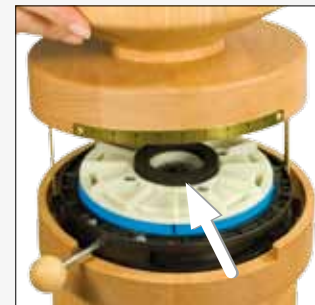
Bild 9 Korrekten Sitz der Moosgummidichtung kontrollieren (Pfeil). Trichter aufsetzen und mit den Messingschrauben wieder befestigen.
