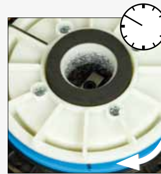
Bild 8 Beachten Sie beim Eindrehen, dass der Mahlstein sich nicht verkantet.
