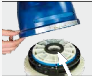
Bild 4 Korrekten Sitz der Moosgummi- midichtung kontrollieren (Pfeil). Trichter aufsetzen und mit Trichter- halterungs- schraube und Einstellhebel befestigen.
