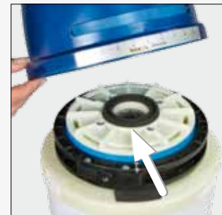
Bild 9 Korrekten Sitz der Moosgummi- midichtung kontrollieren (Pfeil). Trichter aufsetzen und mit Trichter- halterungs- schraube und Einstellhebel befestigen.
