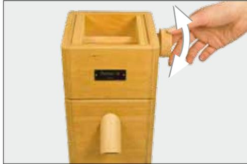
**Bild 1: Zur Einstellung des Feinheitsgrades das Einstellrad drehen.**
