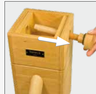
Bild 5 Einstellrad mit Achse seitlich herausziehen.
