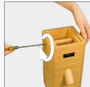
Bild 7 Bremsschraube wieder eindrehen, Leichtgängigkeit des Einstellrades regulieren.
